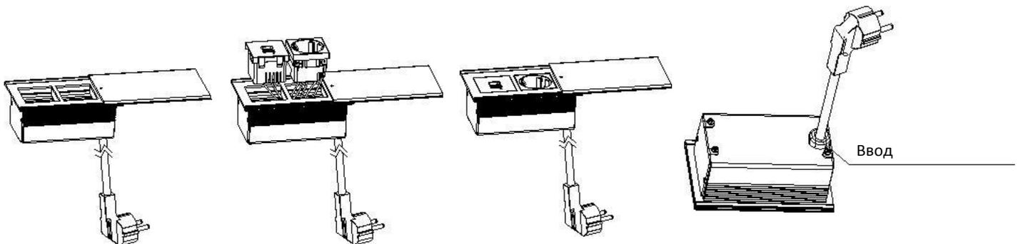
6. Установить блок в предварительно подготовленное монтажное отверстие.
