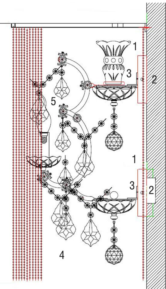
1. Просверлить ударной дрелью в стене отверстия для пластиковых дюбелей. Вставить пластиковые дюбели в просверленные отверстия. Привернуть с помощью саморезов крепежную планку.
