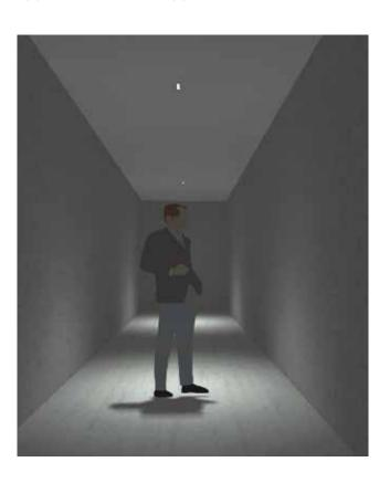
Используется высокоэффективный отражатель, формирующий овальное световое пятно. Такой тип освещения применяется для равномерной засветки протяженных объектов: проходов, проемов, коридоров. За счет глубокого расположения светодиода снижается слепящий эффект.
